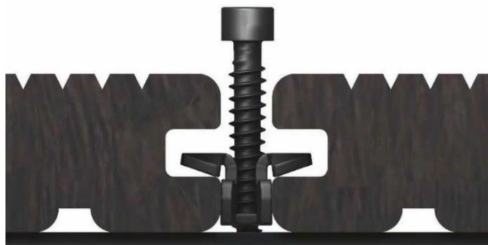
Die Schraube wird soweit festgezogen, dass die elastischen Flügel noch etwas Federweg haben. Keinesfalls darf der Kopf bis zum Boden eingedreht werden.
