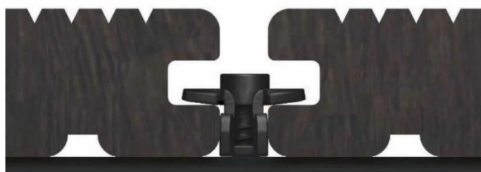
Die letzte Reihe wird wie die erste Reihe befestigt. Breitenzuschnitte von oben sichtbar verschrauben.
